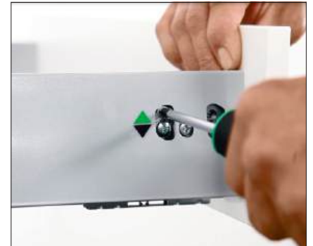
2. Реглаж на височината ( \pm 2 мм) Заклучване на заключващ болт
